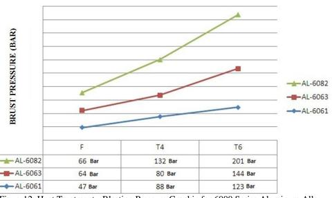
HEAT TREATMENT - BLASTING PRESSURE GRAPHIC FOR 6000 SERIES ALUMINUM ALLOY
